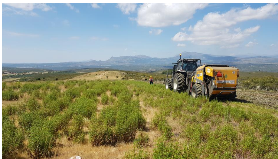
Cosechando jara con la máquina BIOBALER del CEDER-CIEMAT en Berzosa de Lozoya – Madrid.
