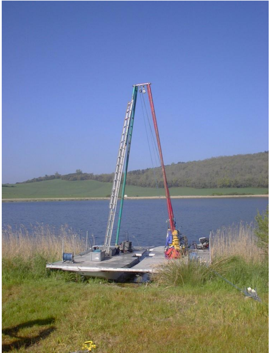
Foto 2: Detalle de la plataforma de sondeos ubicada en la orilla del lago de Caicedo de Yuso-Arreo (Fuente: Blas Valero; IPE-CSIC).
